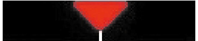
การเชื่อมที่ไม่สมบูรณ์จะทำให้เกิดช่องว่างที่รากซึ่งจะทำให้เกิดการกัดกร่อน
